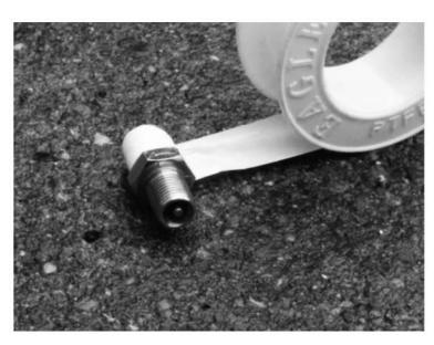
USING AN ADJUSTABLE SPANNER WIND THE SCHRADER VALVE CLOCKWISE AS FAR AS IT WILL GO INTO THE HEX BUSH. YOU WILL PROBABLY NEVER TAKE THE VALVE BACK OUT SO FINISH QUITE TIGHT.
