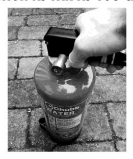
LAY THE CYLINDER FLAT (YOU MIGHT ALSO WANT TO FIRST PLUG THE HOSE CONNECTOR POINT TO STOP LIQUIDS LEAKING OUT). GRIP THE CYLINDER WITH ONE HAND AND WITH THE OTHER PUSH DOWN ON THE OPERATING LEVERS TO TIGHTEN THE VALVE ASSEMBLY FURTHER. IF YOU FIND THIS DIFFICULT THEN CAREFULLY STRIKE THE LEVERS WITH A RUBBER MALLET INSTEAD, BUT TRY NOT TO.
