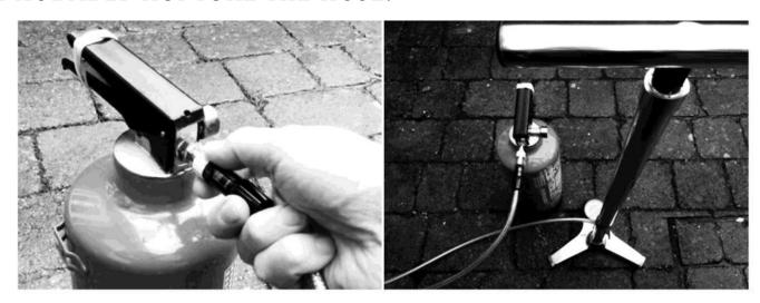
PUMP AIR INTO THE EXTINGUISHER AS FAR AS YOU CAN UP TO THE MIDDLE OF THE GREEN ZONE ON THE PRESSURE GAUGE (NORMALLY AROUND 220PSI / 15 BAR). 200 PSI / 14 BAR IS **ENOUGH TO CREATE A POWERFUL JET THROUGHOUT THE WHOLE** DISCHARGING PROCESS. BELOW THAT, THE JET WILL **EVENTUALLY LOSE POWER AND REACH BEFORE BEING FULLY**
