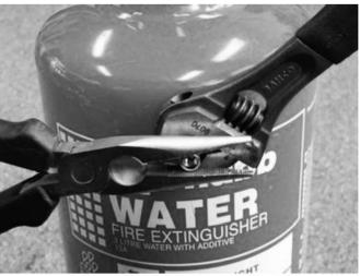
PUT THE VALVE CAP BACK ON BY WINDING IT CLOCKWISE. WHEN EVENTUALLY PRESSURISED, FURTHER TIGHTEN THE CAP WITH PLIERS. IT IS A SECONDARY DEFENCE AGAINST AIR/LIQUID LEAKS. THE MODIFICATION IS NOW COMPLETE.
